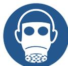
Umgebungsluftunabhängiges Atemschutzgerät bei der Überschreitung von Expositionsgrenzwerten von Stoffen oder in einer schlecht belüftbaren Umgebung.
